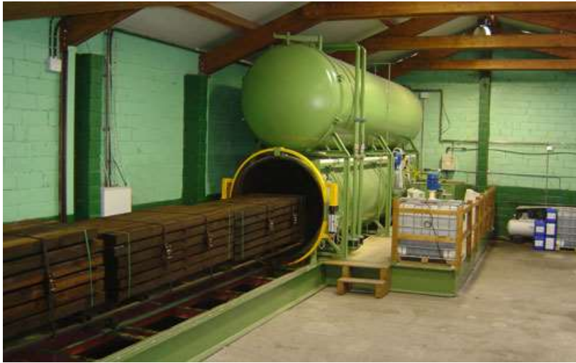
Funcionamiento del tratamiento de autoclave imagen 4ª.
