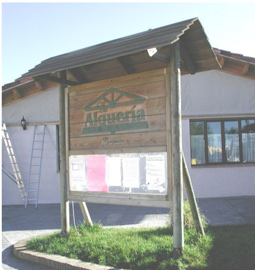
Señal indicadora construido en madera pino cartel grabado y parte inferior en metacrilato para poner información. tratada en autoclave y lasures de protección.
