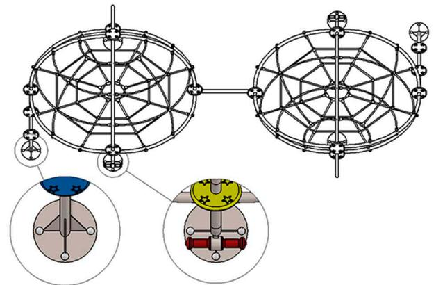
Placas de anclaje soldadas a tubo  $\varnothing 40$  y reforzadas con cartelas
