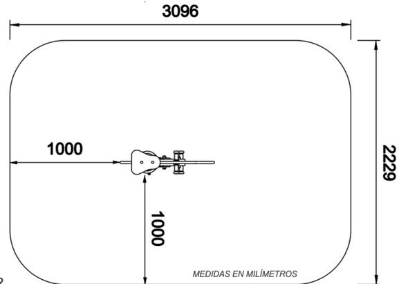
Se deberá instalar el equipo sobre una superficie de áridos (arena, gravilla, etc.) o sobre un suelo amortiguador de impactos (baldosas de caucho), siendo este último el más aconsejable y seguro. Su espesor irá en función de la altura de caída libre del equipo.
