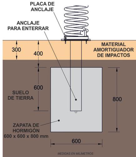
Según norma EN 1176 deberá ser una capa de 200 + 100 mm de grosor y el material empleado podrá ser:
