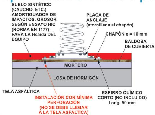
**INSTALACIÓN CON MÍNIMA PERFORACIÓN (NO SE DEBE LLEGAR A LA TELA ASFÁLTICA)**
